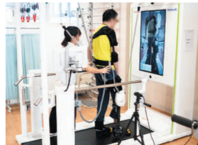
歩行練習支援ロボット ウェルウォーク WW-1000 (トヨタ株式会社製)
